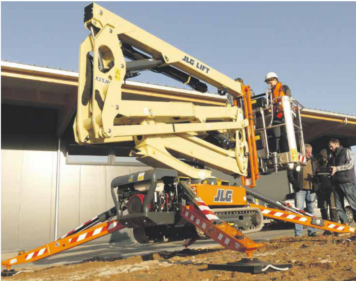
Die kompakte JLG Raupenarbeitsbühne X15J Plus ist klein und leicht, kann aber 230 kg im Korb bewegen.
